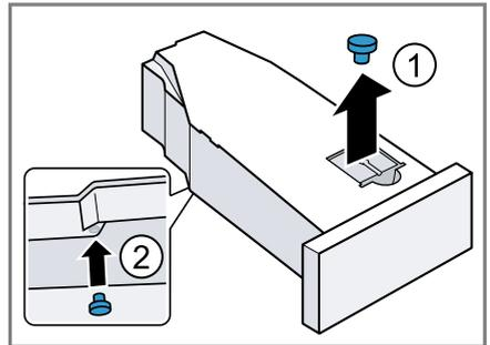
2. Den Filter im Kondenswasserbehälter reinigen.
