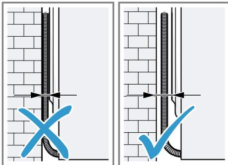
Keine Schläuche und Netzanschlussleitung zwischen Wand und Gerät einklemmen.
