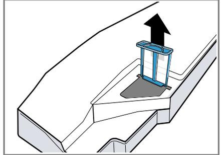
3. Den Filter mit fließendem, warmem Wasser reinigen.
