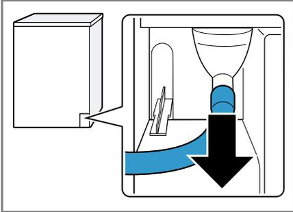
Der Kondenswasserschlauch ist werkseitig am Stutzen angeschlossen.
