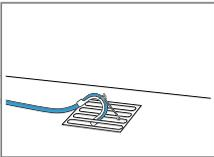
Den Wasserablaufschlauch komplett durch den Krümmer schieben und mit dem Befestigungsmaterial fixieren.
