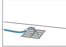
Befestigungsmaterial fixieren. Den Krümmer in maximal 100 cm Höhe befestigen.
