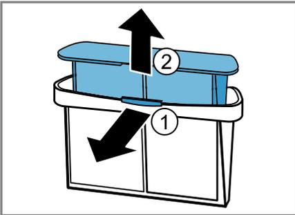
5. Die beiden Flusensiebe öffnen ① und die Flusen entfernen ②.
