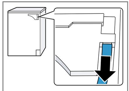
4. Den Wasserablaufschlauch am Wasserablauf anschließen.
